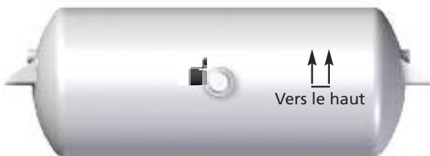
La soupape de commande de freins de remorque doit pointer vers le haut.
