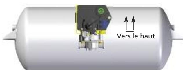
La soupape de relais ABS à 2 orifices doit pointer vers le haut.
