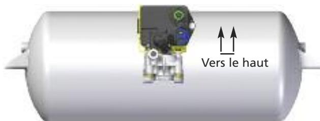
La soupape de relais ABS à 6 orifices doit pointer vers le haut.
