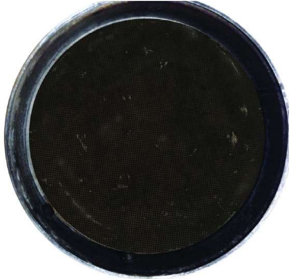
Figure 47 Entrée du filtre à particules diesel (DPF) - Sale, mais réutilisable
