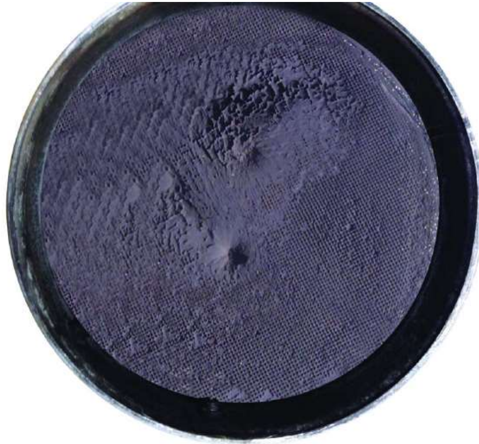
Figure 48 Entrée du filtre à particules diesel (DPF) - Face obstruée
