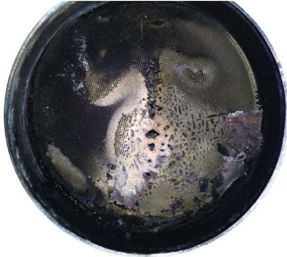
Figure 49 Filtre à particules diesel (DPF) - fondu
