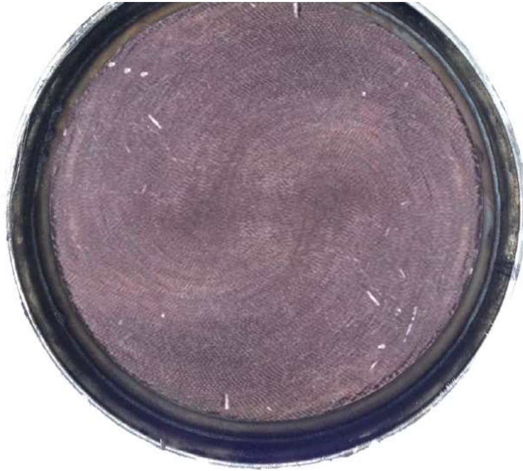
Figure 54 Sortie du convertisseur catalytique d'oxydation diesel (DOC) - sale mais réutilisable.
