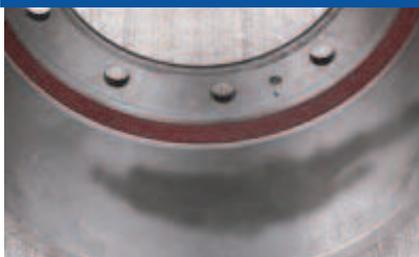
Si cet état apparaît, le tambour de frein présentera une décoloration sur la surface de freinage. Cet état est normalement associé à un système de lubrification défectueux ou un graissage inapproprié des cames de frein. Une fois la provenance de la contamination identifiée et corrigée, les composantes doivent être nettoyées en profondeur et toutes les garnitures de frein contaminées doivent être remplacées.
