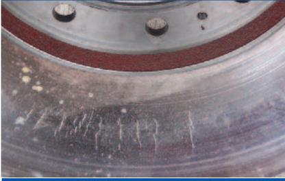
Ce problème est caractérisé par des rainures dessinées dans la surface de freinage du tambour et une usure de garniture de frein excessive. Ces rainures sont dues soit à une usure totale des garnitures de frein entraînant un contact métal contre métal soit à la présence d'un corps étranger ayant pénétré dans la zone du tambour de frein
