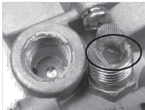
Ces valves ont subi une défaillance prématurée à cause de petits filaments de téflon entrés par les ports et qui se sont déposés sur des éléments clé à l'intérieur de ces valves. Ces filaments de téflon empêchent le bon fonctionnement de ces valves et occasionnent souvent des fuites d'air.
