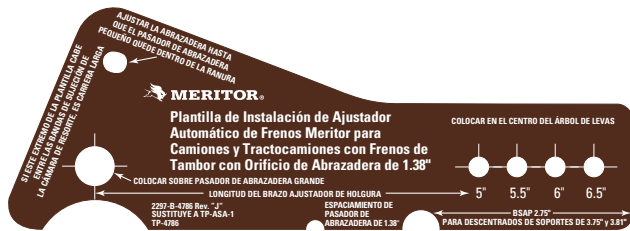
Gabarit TP-4786 pour réglers de jeu automatiques pour camions et remorques avec freins à tambour et bout d'arbre à cames Espacement de 3,5 cm (1,38 po) 1
