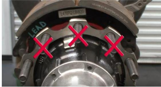
Si un goujon est cassé, il est nécessaire d'en remplacer trois. Si plus d'un goujon est cassé, ils doivent tous être remplacés.
