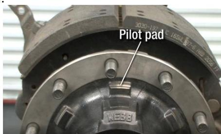
Lors de l'installation, le tambour et la roue, le patin guide doit être fixé à 12 heures.
