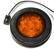
# LU1479AK Feu de gabarit Lentille ambre 4 diodes, Dim. 2½"
